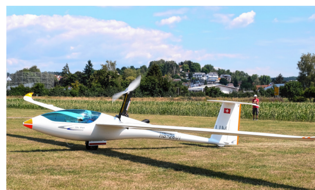
Mit ausgefahrenem Propeller saust das Flugzeug die Graspiste entlang. In der Luft kann der Twin-Shark ein Tempo von bis zu 275 Stundenkilometern erreichen. BILDER: SABINE TESCHKE
